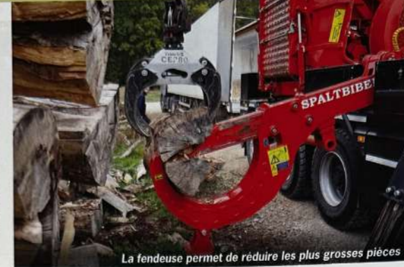
La fendeuse permet de réduire les plus grosses pièces
