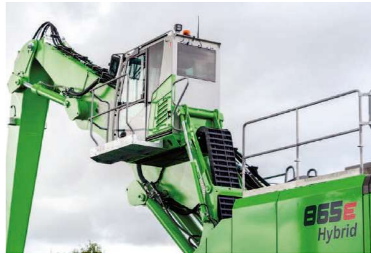
Les solutions vertueuses étaient mises en avant, comme ici avec cette 865E équipée du système de récupération d'énergie GreenHybrid.
